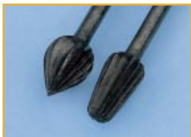
Korozyja świdrów Przyczyna: Sterylizacja narzędzi jednorazowych
