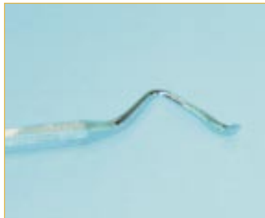
Narzędzie wytrawione resztkami żeluz
