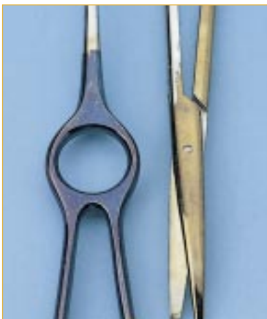
Przebarwienie narzędzi Przyczyna: niedostateczne wypłukanie
