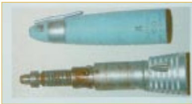
Resztki krwi na uchwycie Przyczyna: niedostatecznie wyczyszczenie
