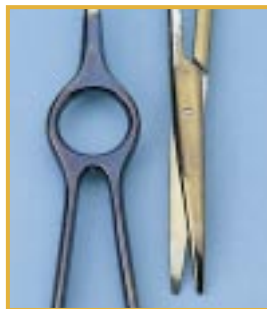
Tęczowe kolory – kolorowe błyszczące pokrycie krzemianowe
