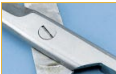
Korożja nożyczek. Przyczyna: brak naoliwienia
