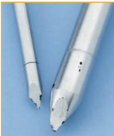
Korozja wżerowa trokaru Przyczyna: duża zawartość chlorku w wodzie
