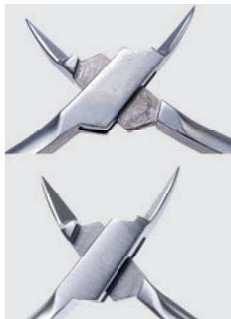
■ Wyczyszczenie i zabezpieczenie przed korozją części trących w złączu
